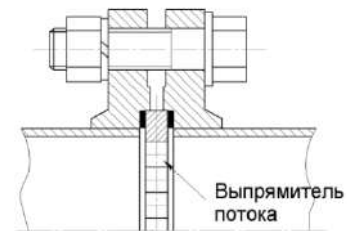
Рисунок 2.8 - Схема монтажа выпрямителя потока
